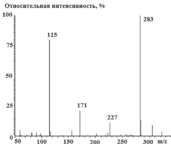
Рис. 2. Масс-спектр (ES) трибутилтиофосфата ( M = 282 , t_R = 14.31 мин). Отнесение пиков: m/z = 283 [M+H]^+ , 227 [M+H-C_4H_9]^+ , 171 [M+H-2C_4H_9]^+ , 115 [M+H-3C_4H_9]^+ \circ [P(OH)_3SH]^+ . Сигналы с m/z = 305 и 322 принадлежат ионам [M+Na]^+ и [M+K]^+ , соответственно.
