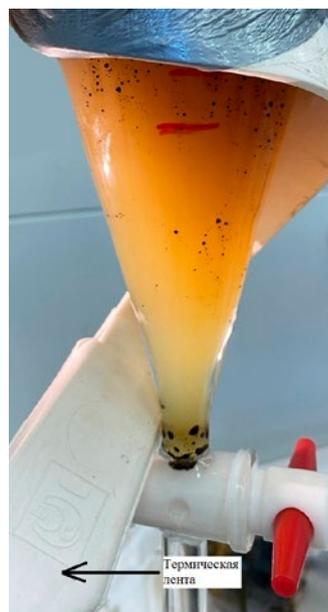
**Рис. 2.** Накопление водной фазы в нижней части нагревательного сосуда
