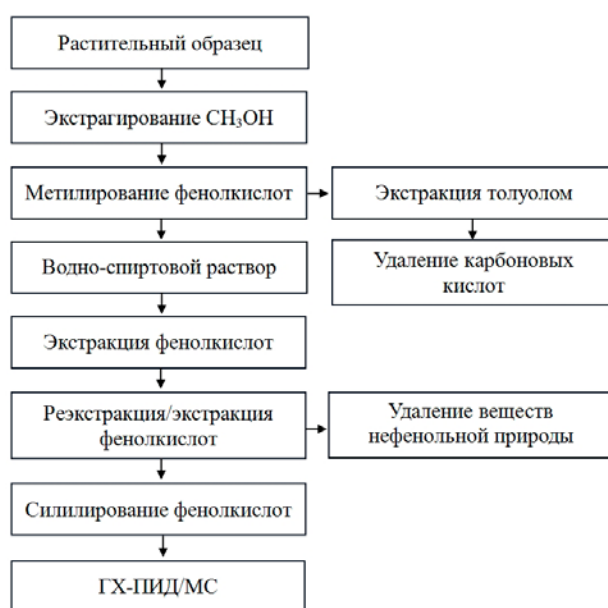
Рис. 2. Аналитический цикл определения фенольных кислот в растительных материалах
