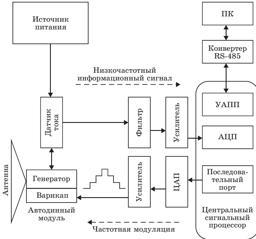
Рис. 6. Функциональная схема РЛД с ПЧ, выполненного на основе автодинного модуля
